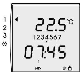
Op het display wordt kortstondig alle aanwezige functies weergegeven; hierna wordt gedurende 3 seconden de software versie getoond.
