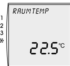
Mit der **Info**-Taste können Sie die gewünschte Raumtemperatur, die aktuelle Raumtemperatur sowie, wenn ein Außenfühler an den Warmlufterzeuger angeschlossen ist, auch die Außentemperatur anzeigen lassen.
