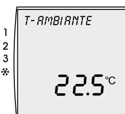
La touche **Info** permet d'afficher la température ambiante souhaitée, la température ambiante actuelle et la température extérieure si une sonde extérieure est connectée au générateur d'air chaud.
