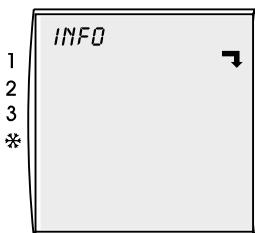
L'affichage de cette flèche met en évidence la présence d'un sous-menu. Il faut appuyer sur le bouton de réglage de droite (menu) pour ouvrir ce sous-menu.
