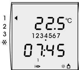
Im Display werden während kurzer Zeit sämtliche vorhandenen Funktionen angezeigt; anschließend wird während 3 Sekunden die Softwareversion angezeigt.
